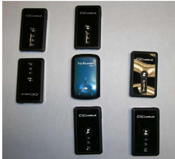
**Figura 11 – Dispositivos de navegación Columbus y Tryp Recorder 747**
