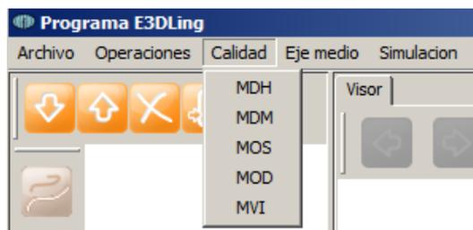
Figura 28 – Algoritmos implementados para determinar la calidad entre dos trazas
