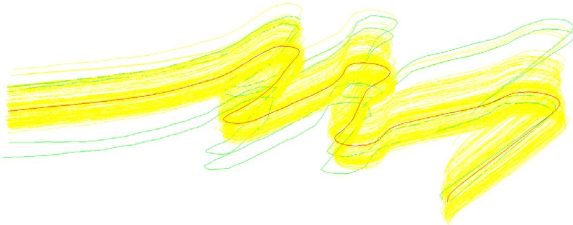
**Figura 18 – Ejemplo de determinación de eje medio mediante la determinación de la distancia de Fréchet de manera iterativa**
