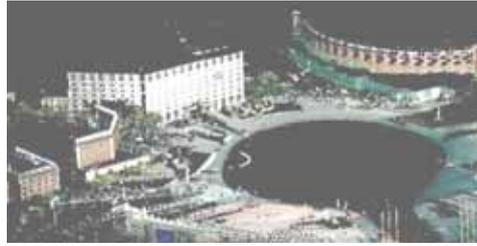
Figura 1. Izq: Escena capturada con el LIDAR terrestre en modo estático codificada como una combinación de intensidad y distancia. Dcha: Plaza de España en Barcelona, escena capturada con el LIDAR terrestre en modo dinámico codificada con los puntos láser RGB.
