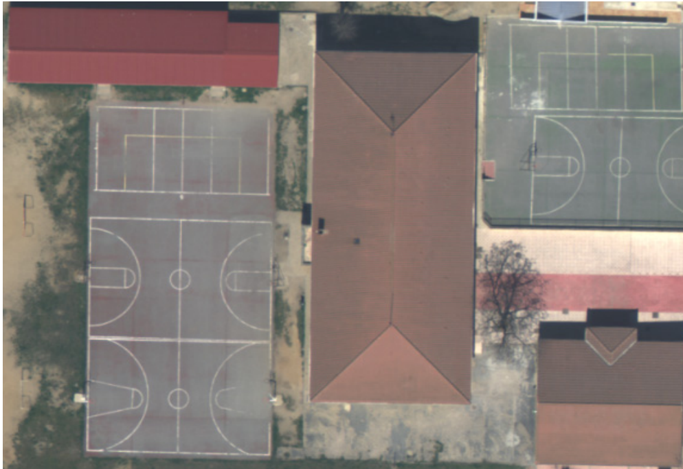
Figura 4. Ejemplo de imagen de captura nadiral sobre una zona urbana en la que se puede observar como los desplazamientos como consecuencia del desplazamiento debido al relieve son prácticamente inapreciables. (Vuelo realizado con ADS40 sobre la ciudad de Ávila con un GSD=10cm).
