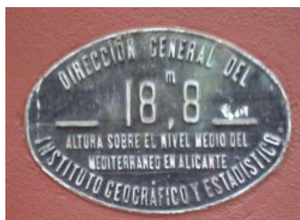
Figura 1. Señal de nivelación.
